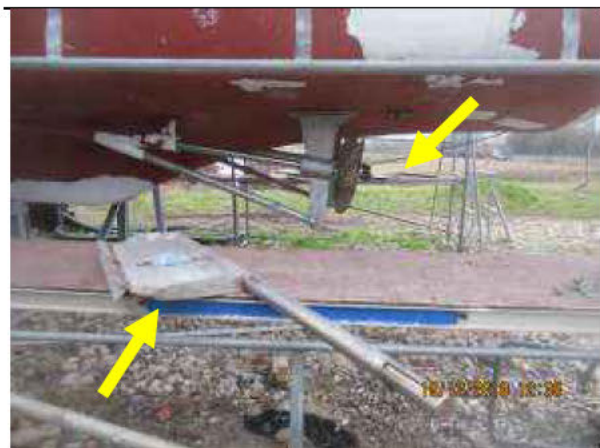
Rør PS og SB nedtaget for tilkomst og inspektion december 2018.
